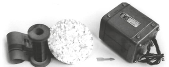
Fig. 57 - matéria prima para a fabricação de um transformador de saída de alta qualidade: o fio de cobre usado para o enrolamento e a chapa de ferro-silício grão orientado. O aço para aplicação elétrica, laminado em forma de chapas-corte de 0,45 a 5% de silício o qual auxilia o crescimento do grão, bem como facilita a sua orientação e reduz as perdas do núcleo.
