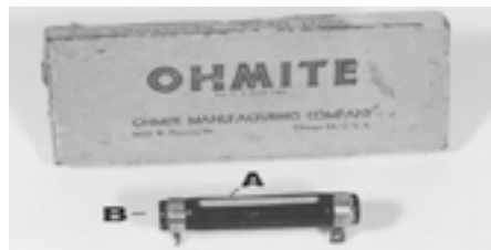
Fig. 51 - o resistor de fio onde: A- enrolamento feito com o níquel-cromo ou constantânio B- base isolante
