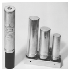
Fig. 46 - ilustração de diversos tipos de capacitores eletrolíticos.
