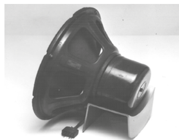
Sonofletores pesados de 15 polegadas tipo triaxial com reproduzidor de alta frequência integrado com o respectivo divisor de frequência.
