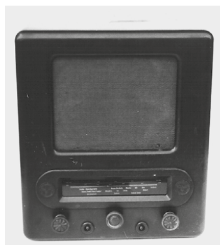
Fig. 37 - receptor de origem alemã feito em grande escala no período de 1933 à 1938 e conhecido como "Deutecher Kleinempfänger" ou receptor alemão tipo pequeno. Fabricado por diversas companhias, era usado pelo governo alemão para difundir a propaganda Nazista. Por este motivo era chamado de "Volkesempfänger" ou rádio do povo.
