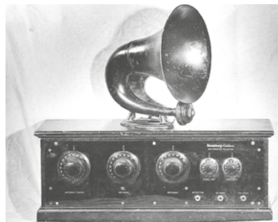
Fig. 34a - radioreceptor marca Stromberg-Carlson de origem americana, fabricado por volta de 1926, operando com circuito tipo neutrodino. (coleção Maria de Oliveira)
