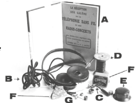
Fig.29 - ilustração da disposição dos componentes eletrônicos de um rádio de construção caseira em 1922.
